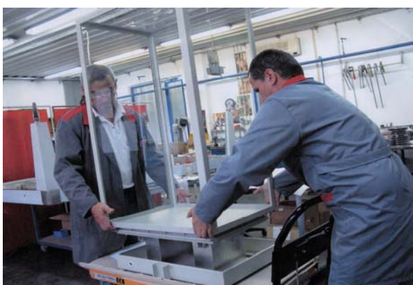
Konstruiranje komore u radionici tvrtke Kambič. Vidi se snažni sustav brtvljenja i demonstrira jakost spoja.
